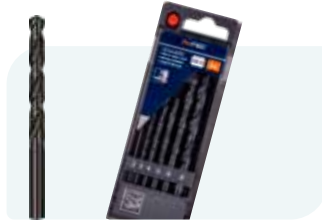
6-dlg. HSS-G spiraalborenset in PVC-cassette Type 100, rolgewalst 1x \phi 2, 3, 4, 5, 6 en 8mm
